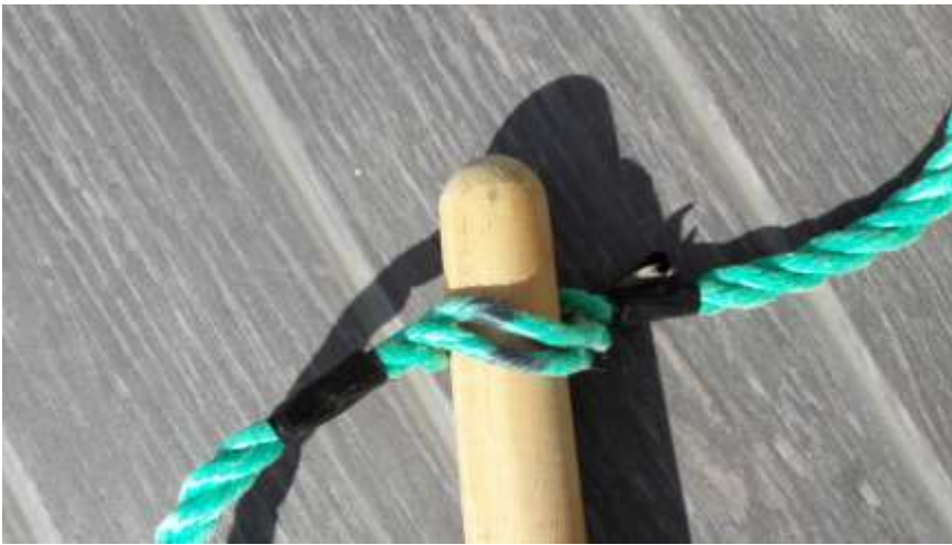
Corde détressée de façon à pouvoir y insérer la tige de bois ou le manche du râteau (en évitant de devoir faire des nœuds). Deux morceaux d'adhésifs sont nécessaires (de part et d'autre) pour ne pas que la corde s'effiloche lorsqu'on tire dessus.
